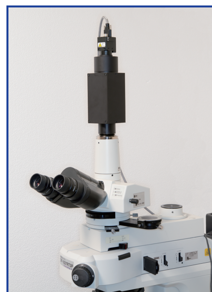
カメラの顕微鏡搭載例
